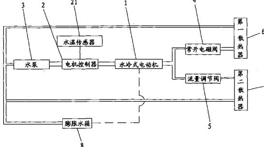
1. 一种电动汽车热管理装置,其特征在于:它包括水冷式电动机、电机控制器、水泵、常开电磁阀、流量调节阀、第一散热器、第二散热器和膨胀水箱;设有水温传感器的电机控制器散热水套通过管路与水冷式电动机的散热水套连接;所述的水冷式电动机的散热水套通过一路管路与常开电磁阀、第一散热器和水泵连接,通过另一路管路与流量调节阀、第二散热器和水泵连接;在水泵进水管路上连接有膨胀水箱,膨胀水箱通过除气管路与水冷式电动机的散热水套的除气口连接;所述的电机控制器通过电线分别与常开电磁阀、流量调节阀、水泵和第一散热器的风扇电机和第二散热器的风扇电机连接。
