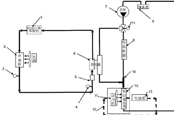
1. 一种电动汽车空气循环电池箱温度管理系统,包括整车控制器、制冷剂循环装置和冷却液循环装置电池箱散热器(10)和电池箱温度传感器,其特征在于,还包括换热器(6)、;
