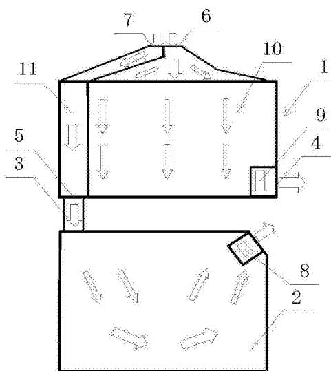
1. 一种动力电池的冷却系统，包括第一电池包与排风口设有第一排气扇的第二电池包，其特征在于：还包括连接第一电池包与第二电池包的弧形过渡风道，所述过渡风道的直径为1.5米；所述第一电池包设有带第二排气扇的第一排风口、第二排风口和与电动汽车乘员舱内连接的第一进风口、第二进风口，第一进风口与第一排风口连通，第二进风口与第二排风口连通，所述第二电池包的进风口与所述过渡风道的一端连接，所述过渡风道的另一端与第二排风口连接；所述第一电池包内设有供第一进风口与第一排风口连通的第一内置风道和供第二进风口与第二排风口连通的第二内置风道；所述第一内置风道与所述第二内置风道的外表面设有隔热材料层，所述隔热材料层为硅橡胶层。
