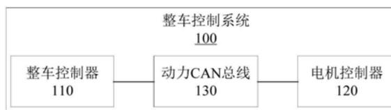
1. 一种整车控制系统,其特征在于,应用于电动汽车,所述整车控制系统包括整车控制器、电机控制器、动力CAN总线,所述整车控制器通过所述动力CAN总线与所述电机控制器连接;
