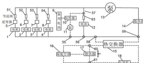
1. 新能源汽车分布式驱动智能化热管理系统,其特征在于,包含一个电机散热单元、一个座舱空调单元及一个电池冷暖控温单元,其中,
