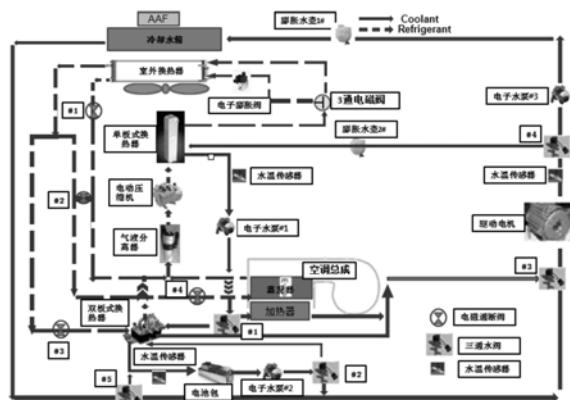
1. 一种新能源汽车热管理系统,包括制冷循环系统和冷却液循环系统以及电池包温控循环系统,其特征在于:所述制冷循环系统和冷却液循环系统之间通过同一换热器I相联进行热交换;所述电池包温控循环系统与制冷循环系统及冷却液循环系统三者之间通过同一换热器II相联进行热交换。
