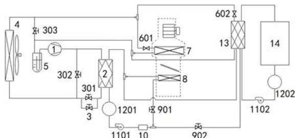
1. 一种新能源车用集成乘员舱空调及电池包热管理热泵系统，其特征在于，含有电动压缩机(1)、水冷冷凝器(2)、电子膨胀阀(3)、第一电磁阀(301)、第二电磁阀(302)、第三电磁阀(303)、室外换热器(4)、液气分离器(5)、第一电磁膨胀阀(601)、第二电磁膨胀阀(602)、车内蒸发器(7)、车内暖风芯体(8)、第一水阀(901)、第二水阀(902)、电加热器(10)、第一电子水泵(1101)、第二电子水泵(1102)、第一水壶(1201)、第二水壶(1202)、复合换热器(13)和电池包(14)，所述车内暖风芯体(8)采用水暖式车内暖风芯体(8)；所述电加热器(10)采用5KW水暖式电加热器(10)；
