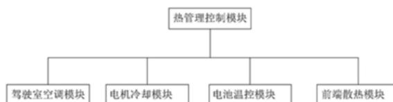
1. 一种新能源汽车热管理系统,其特征在于:包括驾驶室空调模块、电机冷却模块、电池温控模块、前端散热模块和热管理控制模块;驾驶室空调模块、电机冷却模块、电池温控模块、前端散热模块均与热管理控制模块连接;驾驶室空调模块,对驾驶室内温度、湿度进行检测,并将测量的实时数据传给热管理控制模块;电池温控模块对电池包内的温度湿度进行检测,并将检测的实时数据传给热管理空中模块;前端散热模块对电机、电源柜内的温度进行检测,并将实时检测结果传送到热管理控制模块;热管理控制模块,根据收到的驾驶室温度、驾驶室湿度、电池包温度、电池包湿度、电机内部温度、电源柜内部温度信息,判断是否满足要求,并根据判断结果控制各模块工作。
