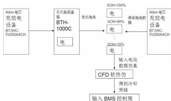
1. 一种新能源汽车用动力锂电池\系统的热管理方法,其步骤包括:
