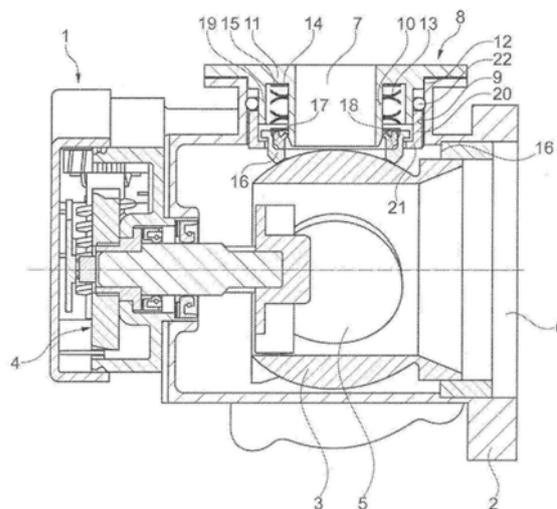
1. 一种热力发动机的热管理模块(1)的管连接件,所述管连接件能够被装入到所述热管理模块(1)的壳体(2)的容纳孔(9)中,其中,能够借助压力弹簧元件(13)相对转阀(3)预压紧所述管连接件(8)的密封圈(16),其特征在于,所述管连接件(8)设有止挡件(24),所述止挡件限制所述密封圈(16)在朝向所述转阀(3)的方向上的纵向运动。
