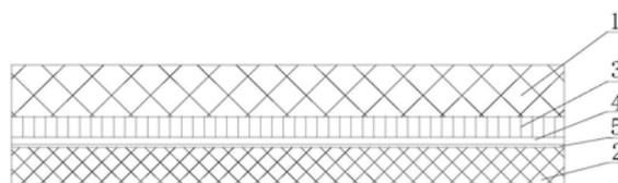
1. 一种红外隐身及热管理布料,包括内层织物层、表层织物层,其特征在于,在表层织物层和内层织物层之间还设有ePTFE膜层,所述ePTFE膜层上设有一层纳米金属膜层。
