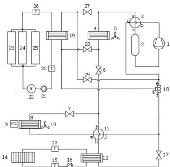
1. 一种电动汽车综合热管理系统,其特征在于,包括热泵循环、电池包循环和电机及其控制系统循环;
