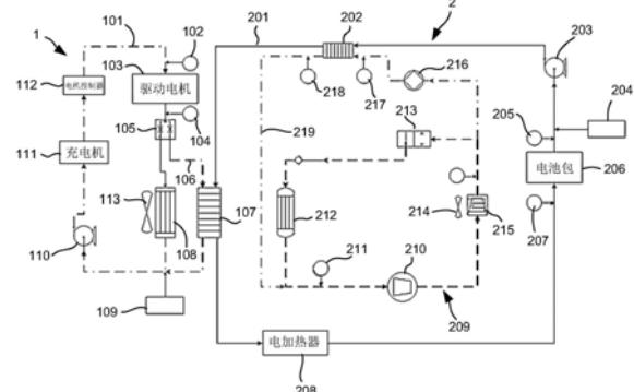
1. 一种热管理系统，包括电机冷却系统(1)和电池热管理系统(2)，其特征在于，还包括三通阀(105)、分支回路(106)和换热器(107)，所述三通阀(105)连接于所述电机冷却系统(1)的驱动电机(103)和散热器(108)之间的第一冷却液回路(101)上，所述分支回路(106)的一端与所述三通阀(105)一个出口连接，所述分支回路(106)与所述第一冷却液回路(101)并联连通，所述分支回路(106)和所述电池热管理系统(2)的第二冷却液回路(201)通过所述换热器(107)并联热交换。
