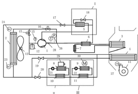
1. 一种补气整焓电动汽车空调热泵系统,其特征在于,包括压缩机、室外换热器、第一室内换热器、第二室内换热器、气液分离器、第一热力膨胀阀、第二热力膨胀阀、第三热力膨胀阀、第一电磁阀、第二电磁阀、第一冷却器以及压缩机补气增焓模块,压缩机补气增焓模块包括第三热力膨胀阀和经济器,
