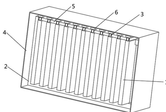
1. 一种锂离子电池导热装置,包括电芯,电芯支架、与电芯连接的极耳及电芯外壳,其特征在于还包括导热板,所述导热板的一端与极耳连接,导热板的另一端与电芯外壳连接,所述电芯、极耳、导热板及电芯外壳之间形成热传导通道,所述电芯外壳作为热传导终端形成储热室。
