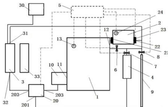
1. 一种整车快速暖机热管理系统,其特征在于:包括发动机、保温瓶、散热器、暖风水箱、整车控制机构、第一电磁阀、第二电磁阀和第三电磁阀;
