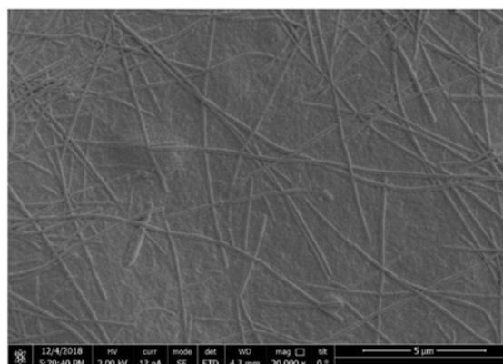
1. 一种柔性高强芳纶纳米纤维复合电热膜,其特征在于:包括银纳米线,银纳米线均匀嵌在芳纶纳米纤维基体表面,芳纶纳米纤维与银纳米线相互连接形成高效导电网络作为电发热载体。
