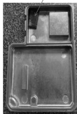
不在黑光下的包含 UV反应性颜料的 热界面
