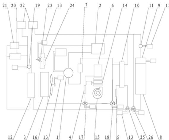
1. 一种全面管理电动车能耗的热管理系统,其特征在於,包括压缩机、内部冷凝器、外部冷凝器、第一膨胀阀、第二膨胀阀、蒸发器、汽液分离器、电池系统、PTC加热器、换热器、第一动力泵和散热水箱,所述电池系统内设有散热装置,所述压缩机、内部冷凝器、外部冷凝器、第一膨胀阀、蒸发器、汽液分离器通过第一管道依次首尾连接,外部冷凝器与汽液分离器通过第一管道连接,外部冷凝器、第二膨胀阀、换热器和汽液分离器通过第一管道依次连接,所述第一动力泵、PTC加热器、电池系统的散热装置和散热水箱通过第二管道依次首尾连接,第一动力泵和电池系统的散热装置通过第二管道分别与换热器连接;
