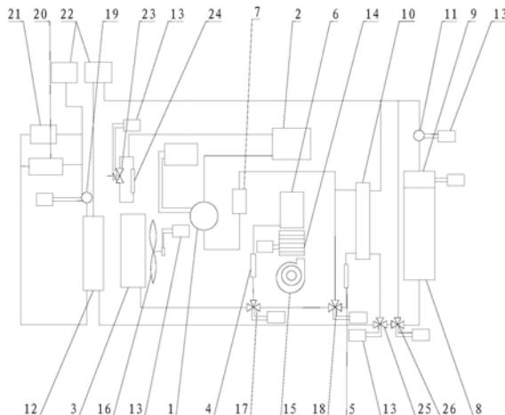
1. 一种全面管理电动车能耗的热管理系统，其特征在于，包括压缩机、内部冷凝器、外部冷凝器、第一膨胀阀、第二膨胀阀、蒸发器、汽液分离器、电池系统、PTC加热器、换热器、第一动力泵和散热水箱，所述电池系统内设有散热装置，所述压缩机、内部冷凝器、外部冷凝器、第一膨胀阀、蒸发器、汽液分离器通过第一管道依次首尾连接，外部冷凝器与汽液分离器通过第一管道连接，外部冷凝器、第二膨胀阀、换热器和汽液分离器通过第一管道依次连接，所述第一动力泵、PTC加热器、电池系统的散热装置和散热水箱通过第二管道依次首尾连接，第一动力泵和电池系统的散热装置通过第二管道分别与换热器连接；
