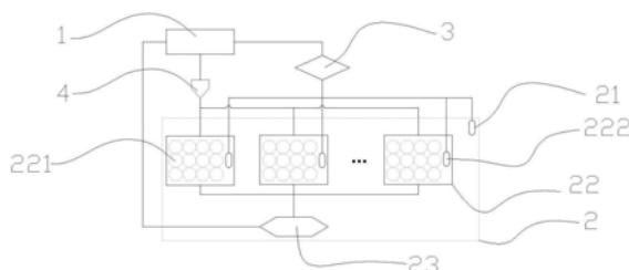
1. 一种热管理系统,将电池舱(2)与空调系统(1)热耦合在一起,所述电池舱(2)内设有一个或多个电池箱(22),其特征在于:所述电池舱(2)内设有换热器,所述空调系统(1)、电池舱(2)、换热器之间形成多级冷却,一冷却介质先从空调系统(1)获得冷量,再送入电池舱(2)内的各个电池箱(22)中吸收所述电池箱(22)内的热量,从所述电池箱(22)中吸收热量后,再流入到所述电池舱(2)内的换热器中,从所述电池舱(2)内吸收热量后最后离开所述电池舱(2)。
