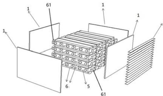
1. 一种高防护等级的空冷式锂电池包热管理系统,其特征在于包括电池包内部的一层或多层电池和/或电池模组、电池包外壳和外置空冷模块,
