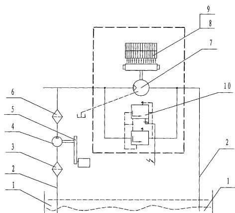
1、多功能快速破碎机的热管理冷却装置，包括油箱（1）、油液管路（2）；其特征在于：在油液管路（2）上设置有吸油滤清器（3）、齿轮泵（4）、出油滤清器（6）、马达（7）和散热器（8），齿轮泵（4）与发动机曲轴（5）连接，产生抽吸作用，使油液从油箱（1）经油液管路（2）进入吸油滤清器（3）、出油滤清器（6）、马达（7）和散热器（8）内，散热降温。
