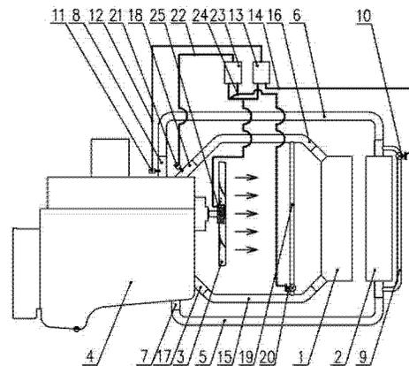
1. 一种恒温式热管理动力机冷却系统, 增压进气中冷器(1)与冷却液散热器(2)以串联的方式安装在一起, 散热风扇(3)装在工程动力机(4)上、靠近增压进气中冷器(1)一侧。
