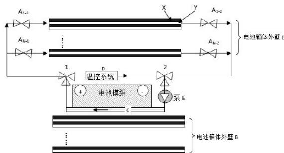
1. 一种具有环境温度自适应性的电池箱系统,包括电池箱,其特征在于,所述系统还包括冷却板、温控系统和循环用管道;
