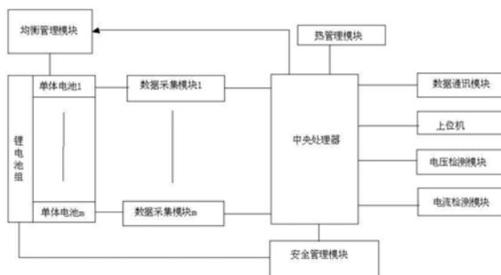
1. 一种锂电池参数采集系统,与待测的锂电池组和电池冷却装置电连接,其特征在于:包括中央处理器、数据采集模块、电压检测模块、电流检测模块和上位机;中央处理器控制各模块工作,接收各模块数据并与上位机进行通讯;数据采集模块与中央处理器和锂电池组电连接,采集锂电池组中各单体电池的电参数数据并将数据传输至中央处理器;电压检测模块与中央处理器电连接,检测锂电池组输出电压并将检测值传输至中央处理器;电流检测模块与中央处理器电连接,检测锂电池组输出电流并将检测值传输至中央处理器;上位机与中央处理器电连接,接收中央处理器数据并实时显示电池状态,通过BP神经网络分析接收到的数据从而对电池状态进行判断,根据判断结果向中央处理器下达相应控制指令。
