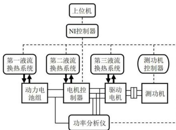
1. 一种电动汽车动力总成能量流测试系统,其特征在于包括动力总成系统、热管理系统以及数据采集系统,
