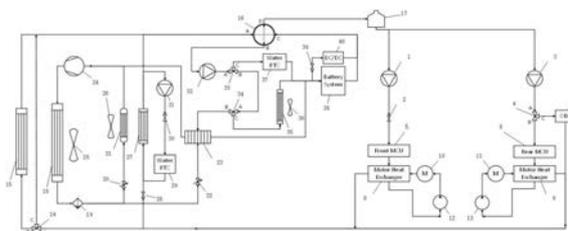
1. 一种智能化多回路电动汽车热管理系统,包括动力电池组(38)、电驱模块、车载充电机(7)、DC/DC转换器(40)、电池散热器(35)、电池制冷器(23)、电机散热器(15)、电动水泵、电动油泵、膨胀水箱(17)、PTC加热器、热交换器、电动压缩机(24)、冷凝器(18)、蒸发器(21)、储液干燥壶(19)、暖风芯体(27),所述的电驱模块包括驱动电机和电机控制器,其特征在于,各组件通过管路以及设于管路中的四通阀(16)、三向阀、直通阀以及电子膨胀阀连接形成多个分别对动力电池组、电驱模块以及乘员舱空调进行热管理控制的回路,包括:
