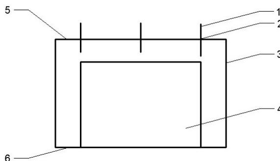
1. 一种具有热管理功能的电池箱,其特征是,所述电池箱由上盖、侧壁和底座形成密闭的电池箱体,满足电池密封、防水的要求,电池置于该密闭的电池箱体之内,在电池箱体上置有对箱体内外热量进行传递的热管,热管的一端置于箱体内部,热管的另一端置于箱体外面,所述热管通过抽真空密封,灌有起相变传热作用的工质。
