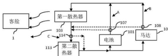
1. 一种电动车辆热管理系统,所述系统借助于从电动车辆的电池和/或电动马达吸收的热量来加热所述电动车辆的客舱,其特征在于,所述系统包括:
