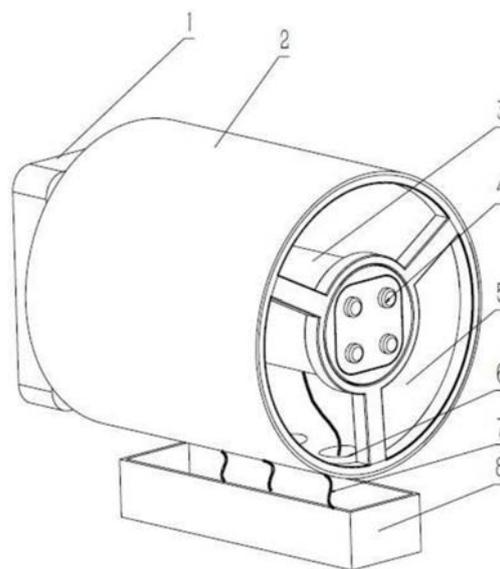
1. 一种风冷结合蒸发膜的电池热管理装置,其特征在于:包括处理器模块、自动补水装置、圆筒状通风外壳(2)、设置在所述通风外壳(2)一端的风扇(1)、通过支架固定在所述通风外壳(2)内孔中的导热性电池体外壳、贴覆在所述电池体外壳表面的吸水蒸发膜(3),所述电池体外壳内放置有电池体(4),所述自动补水装置与吸水蒸发膜(3)相连接,所述处理器模块通过电路连接所述风扇(1),通过检测所述电池体(4)的温度控制所述风扇(1)转速。
