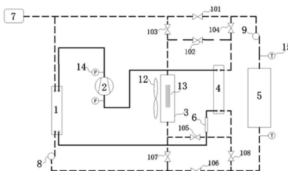
1. 一种动力电池冷却加热管理系统,其特征在于,包括热管理模块和控温模块,所述热管理模块由冷凝器、压缩机、蒸发器通过管路串联组成,所述热管理模块的介质在所述冷凝器的热介质通道和所述蒸发器的冷介质通道内流通;所述控温模块由冷凝器、水箱、蒸发器、散热器通过管路并联组成,所述控温模块的介质在所述冷凝器的冷介质通道和所述蒸发器的热介质通道内流通,所述水箱和所述蒸发器的两端通过分支管路连接,所述水箱和所述蒸发器两端的连接管路上安装有多个切断阀,通过所述切断阀启闭能够使所述控温模块内的部件两两组成连接回路。
