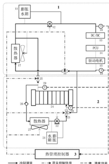
1. 一种增程式燃料电池汽车高效低温启动系统,其特征在于,其包括动力系统平台热管理单元、燃料电池本体热管理单元和热管理控制器;所述热管理控制器分别与动力系统平台热管理单元、燃料电池本体热管理单元连接,所述动力系统平台热管理单元和燃料电池本体热管理单元连接;
