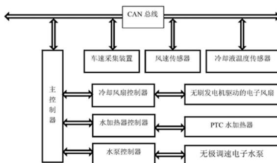
1. 一种水冷发动机智能热管理系统,其特征在于:包括采集汽车车速采集装置、采集水冷发动机外部风速数据的风速传感器、采集水冷发动机内冷却液温度数据的冷却液温度传感器以及冷却液温度智能调节装置,所述车速采集装置、风速传感器、冷却液温度传感器以及冷却液温度智能调节装置采用CAN总线连接;所述冷却液温度智能调节装置包括主控制器,以及与所述主控制器电连接的冷却风扇控制器、水加热控制器、水泵控制器;所述主控制器包括数据接收模块、冷却液温度参数设定模块、和冷却液温度调节模块,其中,
