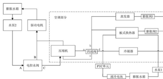
1. 一种纯电动车辆的热管理系统,包括空调系统和电池热管理系统,所述空调系统包括蒸发器、第一膨胀阀、冷凝器,其特征在于,还设有用于与电池热管理系统进行热交换的换热器,所述换热器所在的管路还包括第二膨胀阀。
