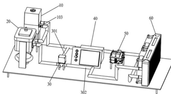
1. 一种汽车发动机热管理系统模拟实训装置,其特征在于,包括:用于储存观察液的存储机构、与上述存储机构出水端管道连接用于加热观察液的加热机构、设置于上述加热机构出水口的温度传感器、以及与上述加热机构出水端管道连接的分流阀;
