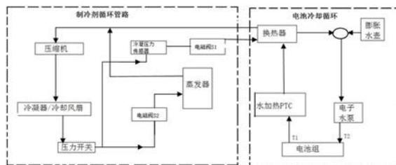
1. 一种电动汽车液冷电池系统,其特征在于:包括整车控制器,所述的整车控制器分别连接液冷电池制冷循环回路、驾驶舱制冷循环回路和动力电池制热/冷回路。
