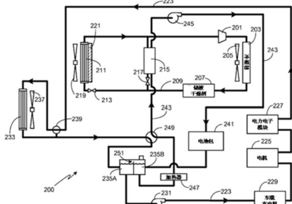
1. 一种新能源汽车热管理系统，其特征在于：包括冷凝子系统、动力总成子系统和电池包子系统，所述冷凝子系统、动力总成子系统和电池包子系统由控制系统进行控制，所述冷凝子系统包括压缩机、冷凝器和蒸发器组成的冷却回路，所述动力总成子系统包括电机、第一冷却水箱、第一水泵以及管路形成的动力回路，所述电池包子系统包括电池包、第二冷却水箱、第二水泵以及管路形成的电池包回路，在所述动力回路连接至第一水箱的进口位置的管路和所述电池包回路连接至第二水箱的出口位置的管路之间安装调节阀，所述控制系统包括设置在系统中的若干传感器和控制模块，所述控制模块根据传感器的信号反馈，对各部件进行控制。
