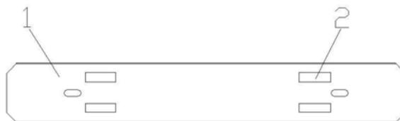
1. 一种带连接扣式弹簧支撑的电池热管理系统装置,包括上板(1),其特征在于,所述上板(1)一侧的两端均固定安装有若干个上板挂钩(2),与所述上板挂钩(2)相邻的一侧设置有下列板(3),所述下板(3)一侧的两端均固定安装有若干个舌勾凸起(4),且舌勾凸起(4)与上板挂钩(2)相匹配。
