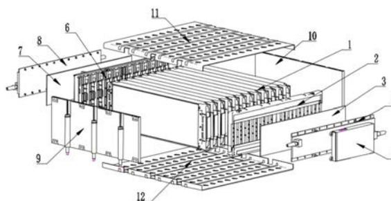
1. 一种极耳冷却的模组结构,其特征在於,包括电芯主体,电芯主体的极耳所在两侧设有塑料框架,以及塑料框架后依次设置的导热绝缘垫和液冷板;电芯主体的另两端设有模组端板;电芯主体的顶部设有模组顶部固定件,底部设有模组底部固定件;
