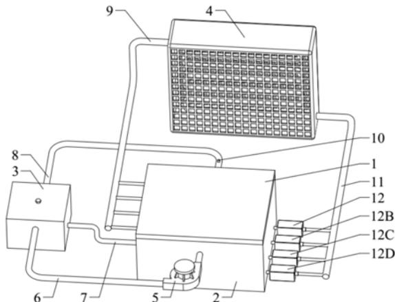
1. 一种吸收式制冷技术的电动汽车电池组热管理装置,其特征是:包括电池箱体、吸收箱、冷凝器和连接管路,其中,所述电池箱体内从下到上依次设置有冷却板、电池单体容纳腔和蒸发箱,所述电池箱体上与蒸发箱对应的位置设置有蒸气管路,所述蒸气管路的另一端连接冷凝器,进入的蒸气在冷凝器的作用后,通过冷流管路连接至所述冷却板处;利用冷凝器的散热作用以及冷却板的蒸发作用,在电池单体容纳腔底部形成冷却区域;
