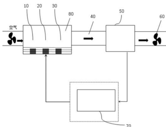
1. 一种电池温度管理装置,其特征在于,包括:冷却模块、雾化模块、加热模块、通风管道、电池包、控制模块、雾化室和送风模块;
