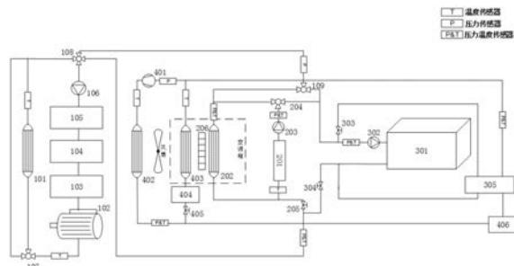
1. 一种电动汽车整车热管理系统，其特征在于，包括电机-散热器回路、PTC加热回路、电池组回路以及空调回路；
