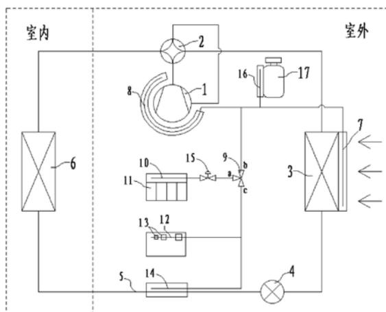
1. 一种电动车热管理系统,包括热泵组件、电池和控制器,其特征在于,还包括热管组件,所述热管组件包括三通阀、布置在热泵组件的室外换热器进风口处的第一冷凝端、布置在所述热泵组件的节流装置与室内换热器之间的冷媒管处的第二冷凝端、布置在热泵组件的压缩机处的第一蒸发端、布置在控制器处的第二蒸发端以及布置在电池处的换热端,所述三通阀的第一端连通所述换热端,所述三通阀的第二端连通所述第一蒸发端和第一冷凝端,所述三通阀的第三端连通所述第二蒸发端和第二冷凝端。
