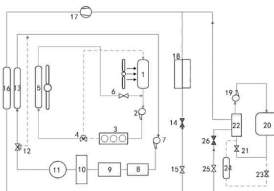
1. 一种增程式电动车热管理系统, 增程式电动车包括为电池发电的发电机, 以及驱动发电机工作的发动机, 其特征在于: 热管理系统包括发动机冷却系统、电驱动冷却系统;
