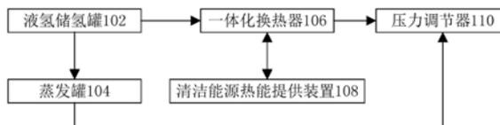
1. 一种液氢加氢站热管理系统,所述液氢加氢站包括用于存储液态氢的液氢储氢罐,其特征在于,所述热管理系统包括:
