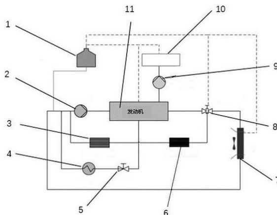
1. 一种适用于增压直喷发动机的整车热管理系统,其特征在于:包括有膨胀水壶(1)、水泵(2)、发动机油冷器(3)、暖风芯体(4)、阀门(5)、变速器油冷器(6)、散热器(7)、电子节温器(8)、电动水泵(9)、增压器(10)和发动机(11);
