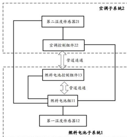
1. 一种燃料电池组和空调联合热管理系统,应用于电动汽车上,包括燃料电池子系统(1)和空调子系统(2),所述燃料电池子系统(1)和所述空调子系统(2)电连接,且所述燃料电池子系统(1)和所述空调子系统(2)通过管道连通,其特征在于,所述燃料电池子系统(1)包括燃料电池组(11)、燃料电池控制组件(13)和用于检测所述燃料电池组(11)的电池温度的第一温度传感器(12),所述燃料电池组(11)分别与所述第一温度传感器(12)和所述燃料电池控制组件(13)电连接,且所述燃料电池组(11)通过管道与所述燃料电池控制组件(13)连通;
