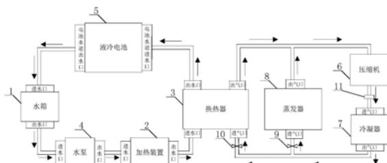
1. 一种应用于电动汽车动力电池的整车热管理系统，包括：液冷电池；其特征在于，还包括：液冷管路、加热装置及水泵，所述加热装置、水泵及所述液冷电池的电池水道设置在所述液冷管路上；所述水泵将所述加热装置加热后的循环水输送至所述液冷电池的电池水道内，使所述液冷电池升温；
