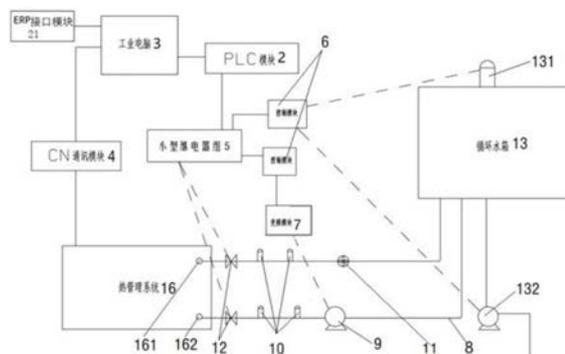
1. 热管理系统在线测试系统,其特征在于,包括:控制柜、PLC控制器、工业电脑、CN通讯模块、小型继电器组、控制器组、变频模块、测试管路、测试循环泵、传感器模块组、流量计、气动阀、循环水箱、电加热棒和排污水泵,所述PLC控制器、工业电脑、CN通讯模块、小型继电器组、控制器组、变频模块、测试管路、测试循环泵、传感器模块组、流量计、气动阀均集成设置在所述控制柜内,所述测试管路上设置有气动阀、传感器模块组、流量计、测试循环泵和循环水箱,所述小型继电器组、传感器模块组和流量计分别与PLC控制器通过导线连接,所述测试循环泵依次通过变频模块、控制器组与小型继电器组连接;所述气动阀通过导线与小型继电器组连接;
