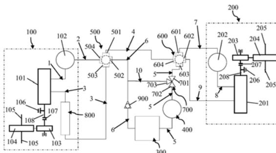
1. 一种电机驱动与电池热管理的集成系统,其特征在于,包括第一驱动总成(100)、电池包(300)和第一四通阀(500);
